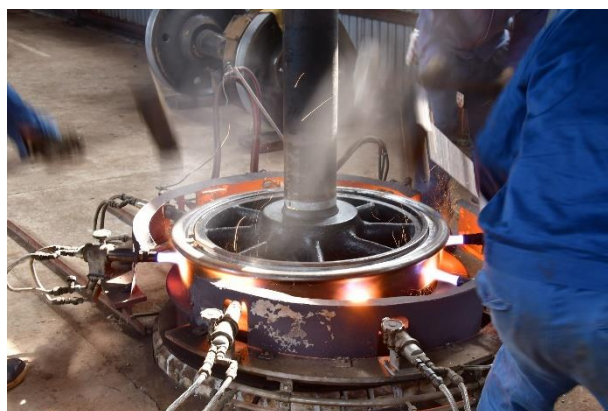
蒸気機関車(炭水車)車輪嵌替の様子
