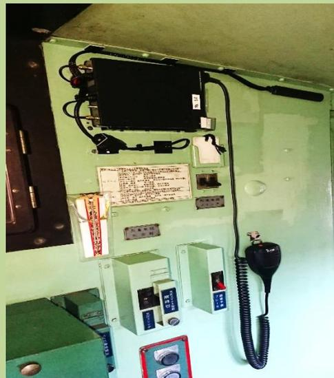
電気機関車運転台搭載 IP 無線機
