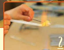
2 ガスバーナーでガラス棒を溶かし、専用のステンレス棒に巻き付けていく。溶け始めたらスピード勝負！
