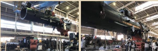
SL全般検査とは、車両すべての機器類を取り外し、全般にわたり細部まで検査を行うことで、略して「全検」とも呼ばれます。当社の車両工場では検査を行うことができず、JR東日本 大宮総合車両センターへ委託しております。11月に、同センターでボイラーを台枠に載せる作業が行われました。2月の運行に向け、元の姿に近づきつつあります。
