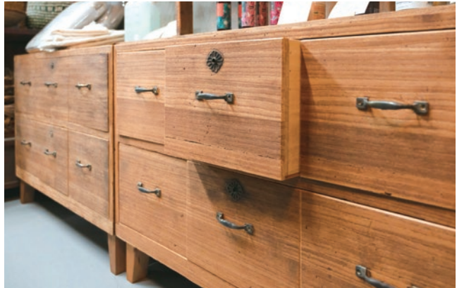
桐筆筒を「お直し」した桐チェスト 使用感を残しながらサンドペーパーで削った桐筆筒の引き出しを3分割にカット。仕切りは同じ桐材で制作。
